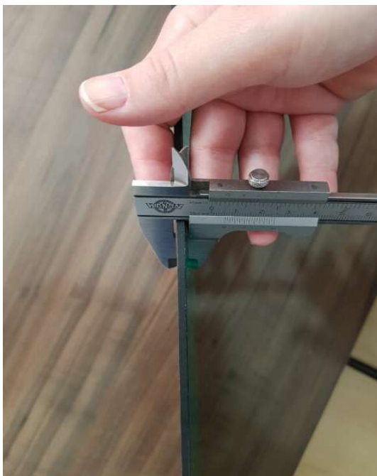
(imagem da amostra da placa de fenol mostrando que atende a medida exigida no item 01, de 3mm)
