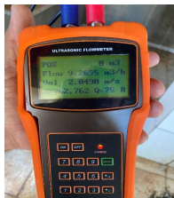
Figura 43 - Medidor Ultrassônico de Vazão
