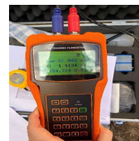
Figura 40 - Medidor Ultrassônico de Vazão
