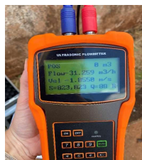
Figura 38 - Medidor Ultrassônico de Vazão
