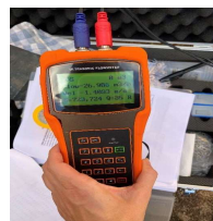
Figura 39 - Medidor Ultrassônico de Vazão
