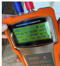
Figura 44 - Medidor Ultrassônico de Vazão
