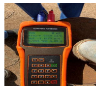
Figura 41 - Medidor Ultrassônico de Vazão
