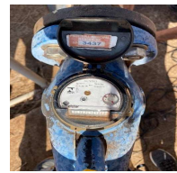
Figura 19 - Medidor destacando-se o totalizador de volumes captados.
