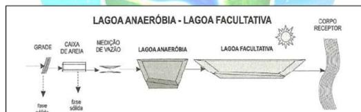
Figura 49 - Esquema geral do sistema de tratamento de esgoto
