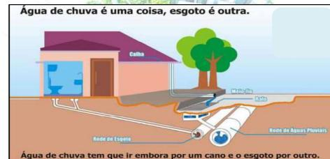
Figura 56 – Detalhe genérico do sistema de drenagem e esgoto
