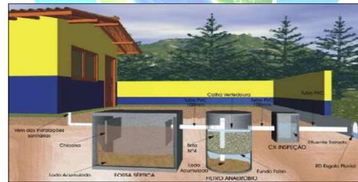
Figura 69 – Tanque séptico + filtro anaeróbio + sumidouro
