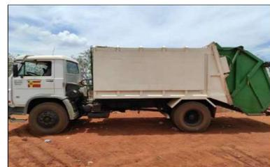
Figura 62 – Caminhão compactador utilizado na coleta dos resíduos sólidos
