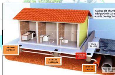
Figura 46 - Esquema do sistema de captação do esgoto domiciliar para a rede pública.
